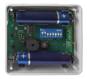
Fig. 3.4.2: Insert batteries
