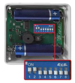
Fig. 3.5.2: Coding the humidifier
